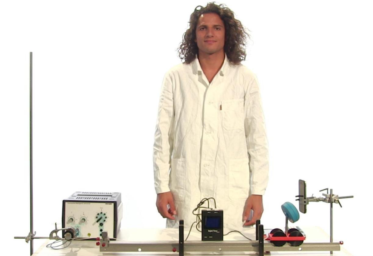
Die Schienen werden mit den Verbindungsstücken zusammengesetzt (3 Schienenteile sind passend) und auf die 2 Lichtschranken aufgelegt (30cm Abstand der Lichtschranken). Die Lichtschranken sind mit dem „Digitalen Timer“ verbunden. An einem Ende der Schienen befestigt man den Stopper, am anderen wird mit einer Stativstange und einer Klemme das Smartphone mit der App Phyphox/Dopplereffekt angebracht.
