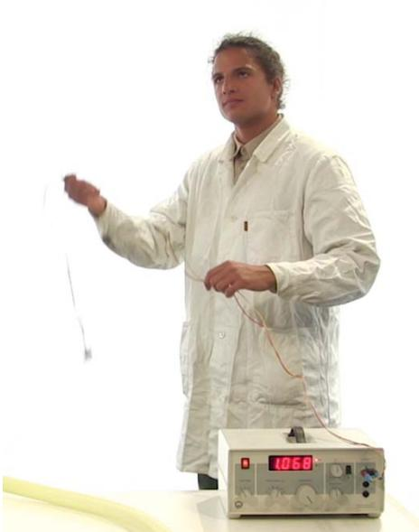
Der Lautsprecher wird mit dem Tongenerator verbunden und zusätzlich an dem Seil oder Draht befestigt. Beim Tongenerator wird eine feste und hörbare Frequenz eingestellt (zwischen 20 – 20.000Hz). Auch hier erfolgt die Drehung mit konstanter Geschwindigkeit.
