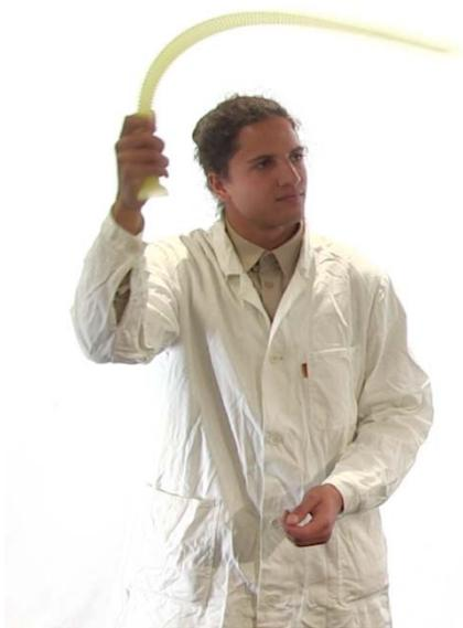
Die Röhre wird an einem Ende gefasst und über dem Kopf gehalten. Nun wird die Röhre mit konstanter Geschwindigkeit gedreht.
