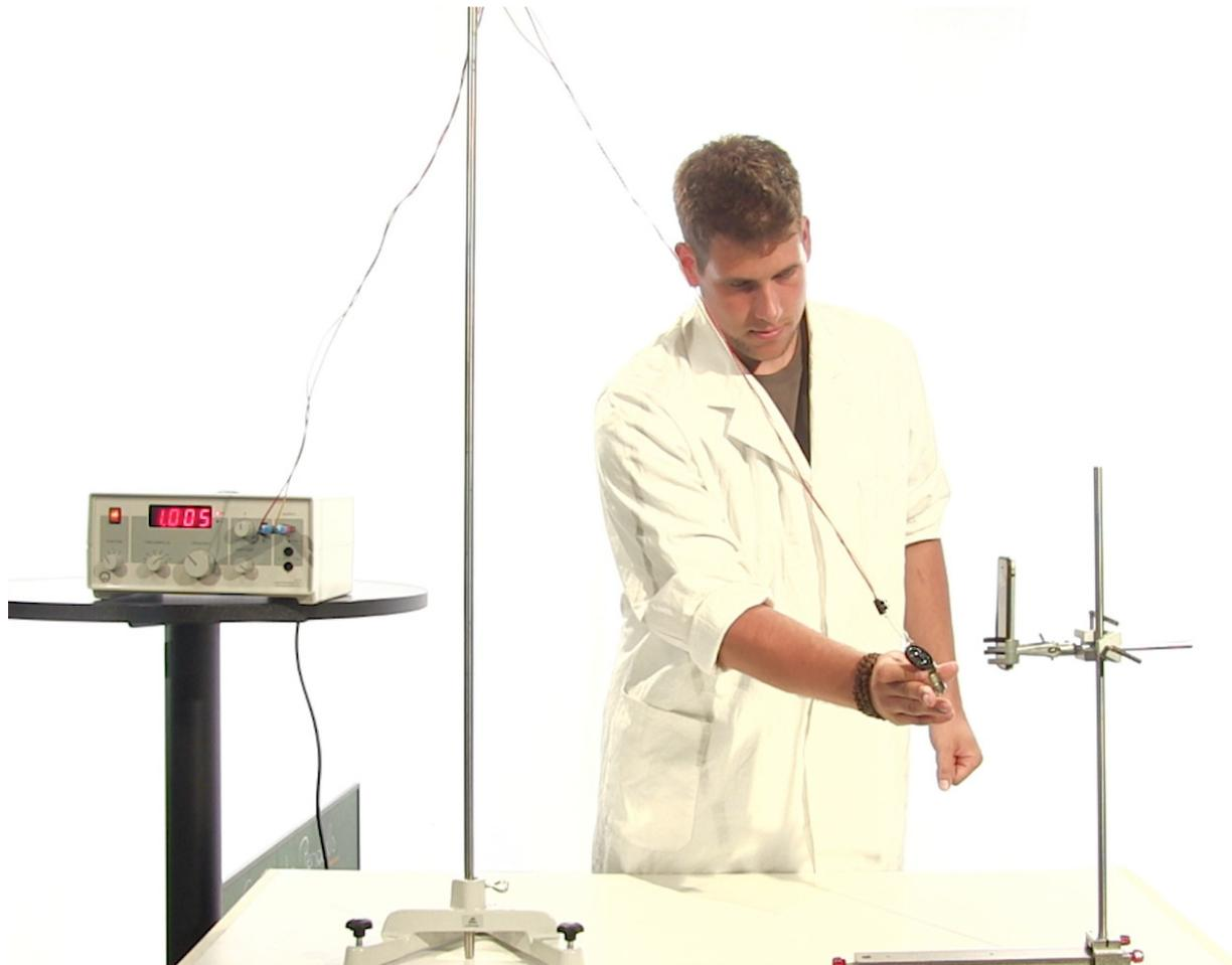
Die lange Stativstange in den Stativfuß stecken und am oberen Ende die Aufhängung für das Pendel so anbringen, dass das Pendel dann frei schwingen kann. Den Faden an der Aufhängung befestigen und den Pendelkörper daran hängen. An den Pendelkörper zusätzlich noch den Lautsprecher hängen, dieser wird mit dem Frequenzgenerator verbunden.
