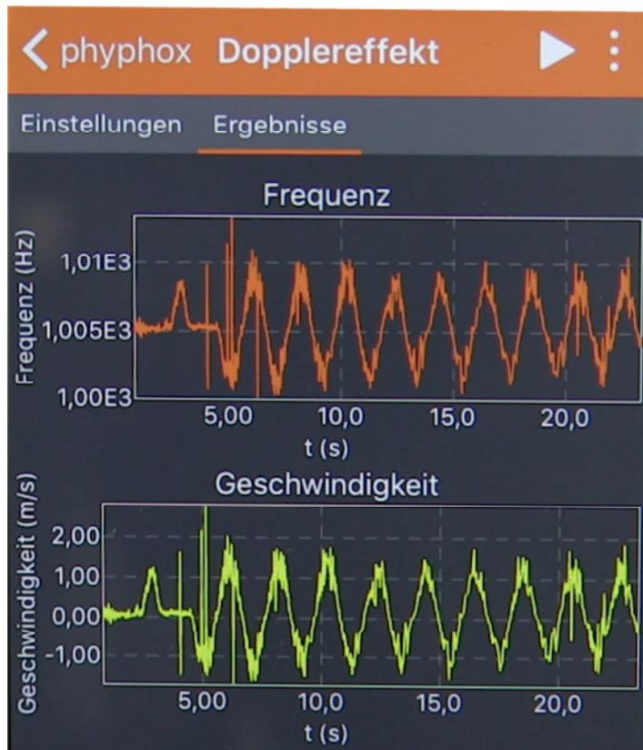
Am oberen Frequenz-Zeit-Diagramm kann man sehen, dass die aufgenommene Frequenz in der Ruhelage des Pendels vor dem Auslenken konstant ist. Der erste Peak nach oben kommt vom Auslenken des Pendels hin zum Smartphone. Danach kann man sehr schön die periodische Bewegung des Pendelkörpers sehen, wobei ein Peak nach oben einer Bewegung des Pendels zum Smartphone hin entspricht, ein Peak nach unten dem Wegbewegen des Lautsprechers vom Mikrofon.
